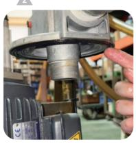
使用牛油均匀塗抹油封,並確認其未 鬆動或脫落,避免安裝罐體時掉落。
