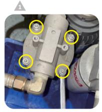
鬆開並拆下吸油濾油網座上方的四顆 螺母。
