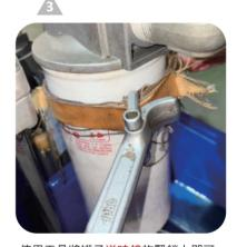
使用工具將罐子<mark>逆時鐘</mark>旋緊鎖上即可。 Simply use a tool to tighten and secure the jar counterclockwise.
