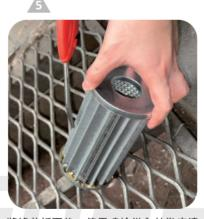
將濾芯拆下後,使用噴槍從內外徹底清潔,再以乾淨油沖洗乾淨後重新安裝。
