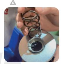
請確實安裝底部彈簧,壓到底聽見「卡」 聲後,即可放回罐內。
